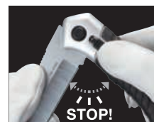
Mécanisme de blocage par bouton coulissant de sécurité
