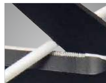
Haltekerben am Beginn der Schneide für Drähte und runde Materialien
